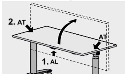
Auslöser **AL** betätigen und Tischplatte in die senkrechte Position klappen. Mit **AT** arretieren.
