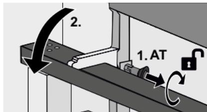
Die zwei Bolzen **AT** entriegeln und den Tisch umklappen.
