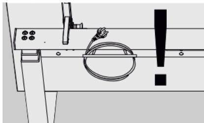
Sicherung des Stromzuführungskabels durch Aufwickeln am vorgesehenen Steg.
