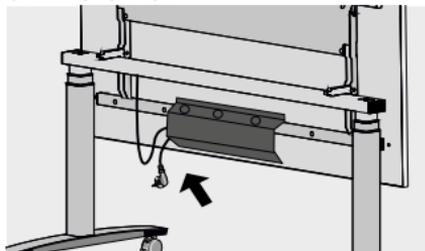
Sicherung des Stromzuführungskabels im Kabelkanal oder am Kunststoffclip.
